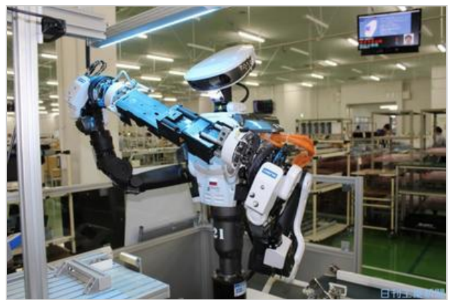
可巧妙變換角度，利用頭部及指尖的攝影機針對 70 多處進行目測檢查
