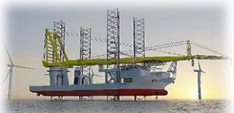
自升式安裝船 (風機安裝)
